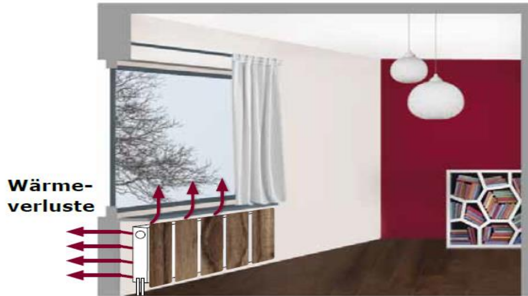
Verkleidung der Heizkörpernische
