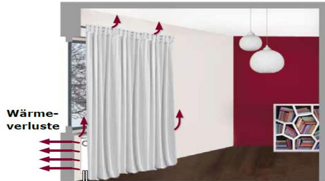
Vorhänge vor Heizkörpern
